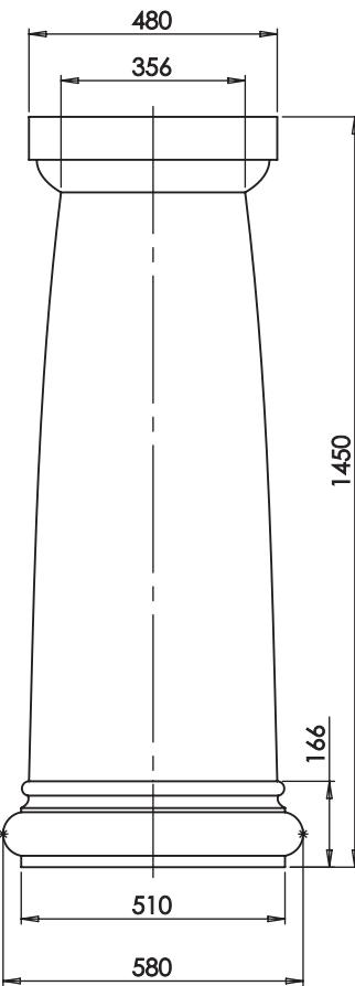
Maskownica wylotu pary – przeznaczona do łazienek okrągłych jako element centralny pomieszczenia
